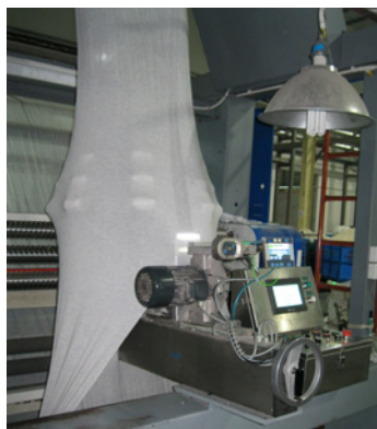
ELCUT BTA 2535 na instalação de corte do tubo
